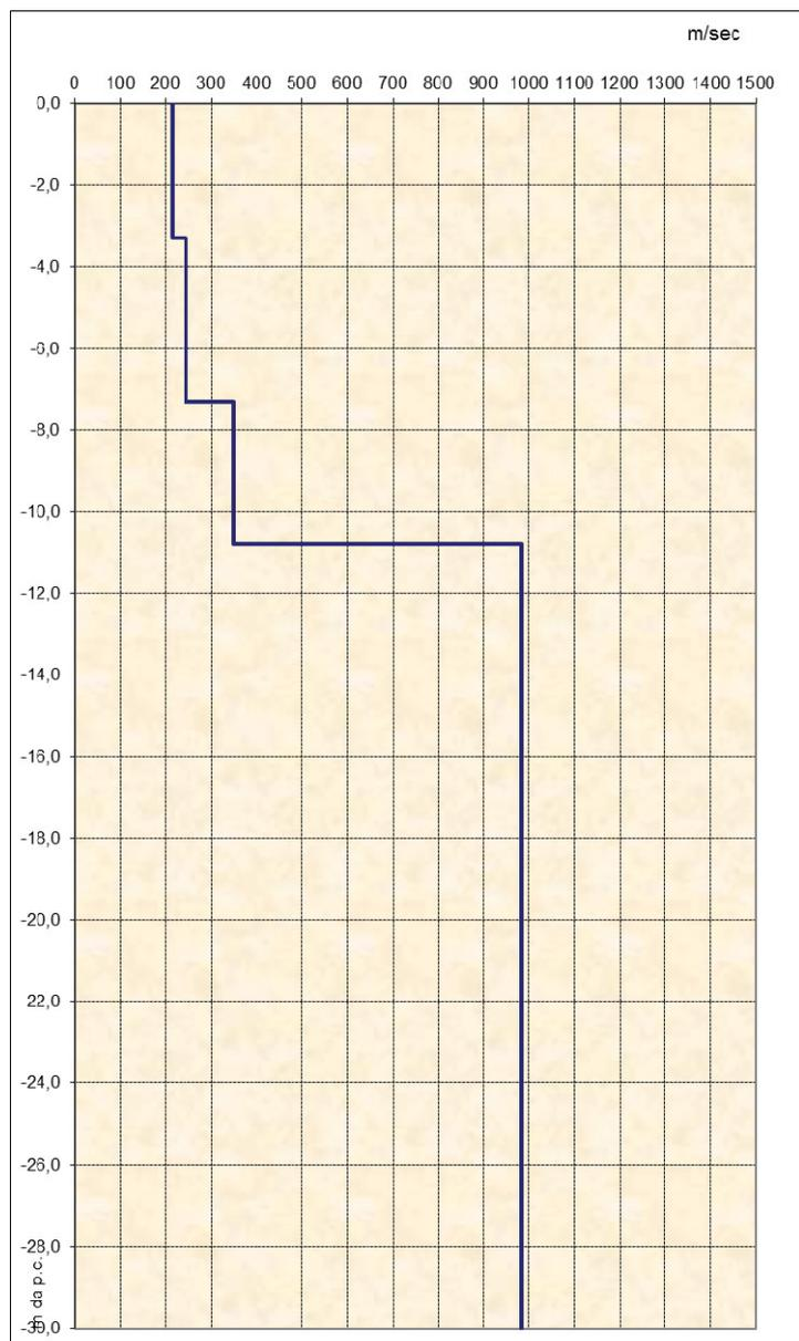
Figura 18 - Diagramma velocità  $V_s$ /profondità
